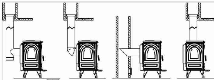
Principe de raccordement général pour buse dessus ou arrière (si possible)
